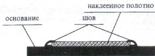
Рис. 19. Схема наклейки полотна и выхода мастики.
